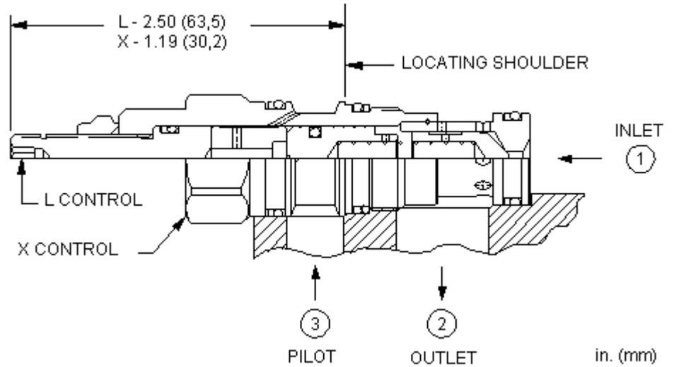
Dieses Ventil ist ein in der Ruhestellung geschlossenes, sperrbares Rückschlagventil mit einem Zusteuerungsverhältnis von 20:1. Das Ventil erlaubt einen Durchfluss von Anschluss 1 nach 2 und blockiert in umgekehrter Richtung. Druck am Zusteueranschluss 3 wirkt dem Druck an Anschluss 1 im Verhältnis von 20:1 entgegen.
