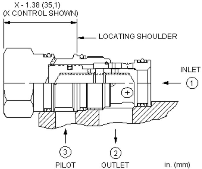
Dieses Ventil ist ein in der Ruhestellung geschlossenes, sperrbares Rückschlagventil mit einem Zusteuerungsverhältnis von 1,8:1. Das Ventil erlaubt einen Durchfluss von Anschluss 1 nach 2 und blockiert in umgekehrter Richtung. Druck am Zusteueranschluss 3 wirkt dem Druck an Anschluss 1 im Verhältnis von 1,8:1 entgegen. Dieses Ventil findet hauptsächlich in Eilgangschaltungen Verwendung.
