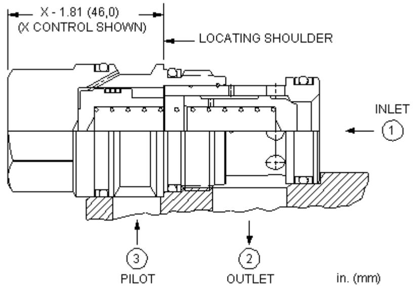
Dieses Ventil ist ein in der Ruhestellung geschlossenes, sperrbares Rückschlagventil mit einem Zusteuerverhältnis von 1,8:1. Das Ventil erlaubt einen Durchfluss von Anschluss 1 nach 2 und blockiert in umgekehrter Richtung. Druck am Zusteuersanschluss 3 wirkt dem Druck an Anschluss 1 im Verhältnis von 1,8:1 entgegen. Dieses Ventil findet hauptsächlich in Eilgangschaltungen Verwendung.
