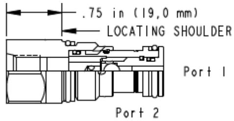
Le sélecteur de circuit simple bille relie la plus élevée des 2 lignes de pression à l'orifice du signal. Le signal de pression arrive sur un orifice externe situé dans la partie hexagonale de la cartouche.
