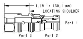
Das Wechselventil verbindet die Hochdruckseite zweier Zuläufe mit dem Signalabgriff. Der Signalabgriff ist an
