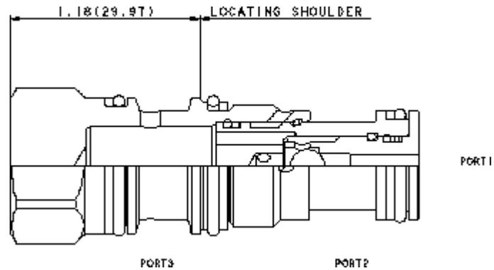
Le sélecteur de circuit simple bille relie la plus élevée des 2 lignes de pression à l'orifice du signal. Le signal de pression arrive sur l'orifice 3.
