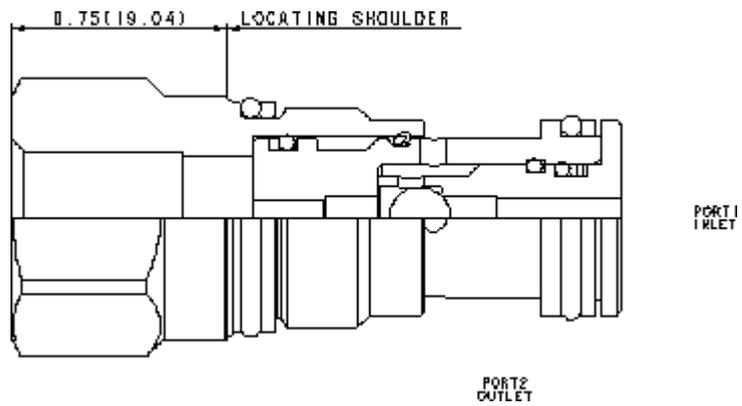
Das Wechselventil verbindet die Hochdruckseite zweier Zulaufe mit dem Signalabgriff. Ein Zulauf ist im Sechskant vom Ventilkopf und der Signalabgriff an Anschluss 2.
