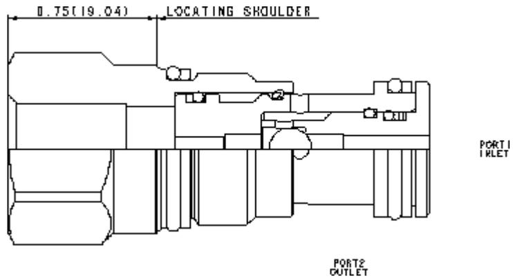
Le sélecteur de circuit simple bille relie la plus élevée des 2 lignes de pression à l'orifice du signal. L'une des 2 lignes de pression correspond à un orifice externe situé dans la partie hexagonale de la cartouche; le signal de pression arrive sur l'orifice 2.
