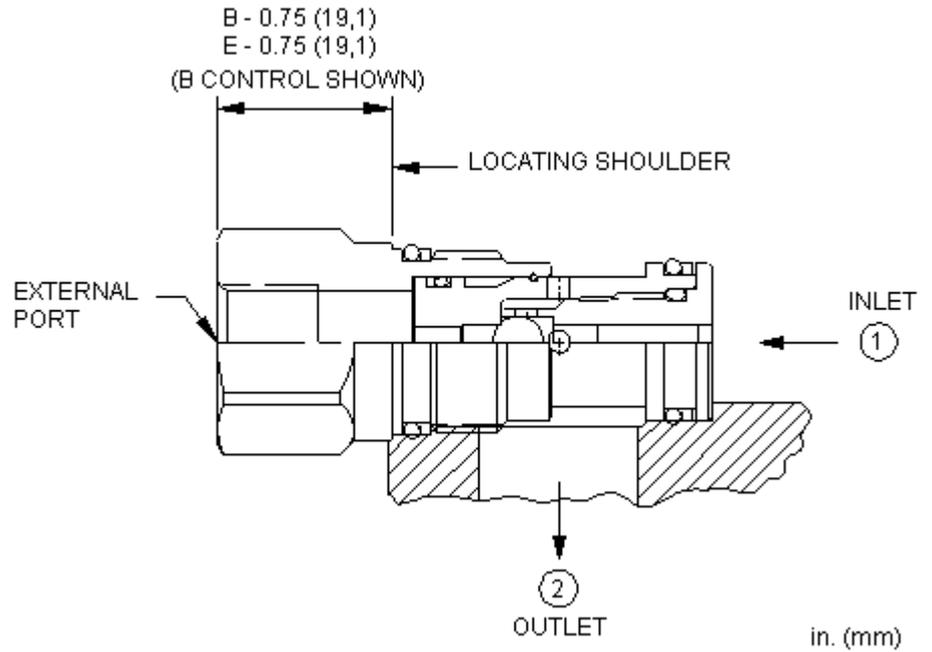
Le sélecteur de circuit simple bille relie la plus élevée des 2 lignes de pression à l'orifice du signal. L'une des 2 lignes de pression correspond à un orifice externe situé dans la partie hexagonale de la cartouche; le signal de pression arrive sur l'orifice 2.
