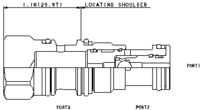
Das Wechselventil verbindet die Hochdruckseite zweier Zulaufe mit dem Signalabgriff. Der Signalabgriff ist an Anschluss 2.
