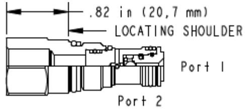
Le sélecteur de circuit simple bille relie la plus élevée des 2 lignes de pression à l'orifice du signal. Le signal de pression arrive sur un orifice externe situé dans la partie
