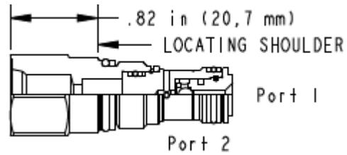
Das Wechselventil verbindet die Hochdruckseite zweier Zuläufe mit dem Signalabgriff. Der Anschluss für den externen Signalabgriff ist im Sechskant vom Ventilkopf.
