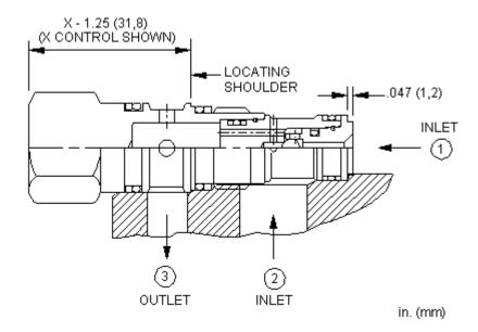
Le sélecteur de circuit simple bille relie la plus élevée des 2 lignes de pression à l'orifice du signal. Le signal de pression arrive sur l'orifice 3.
