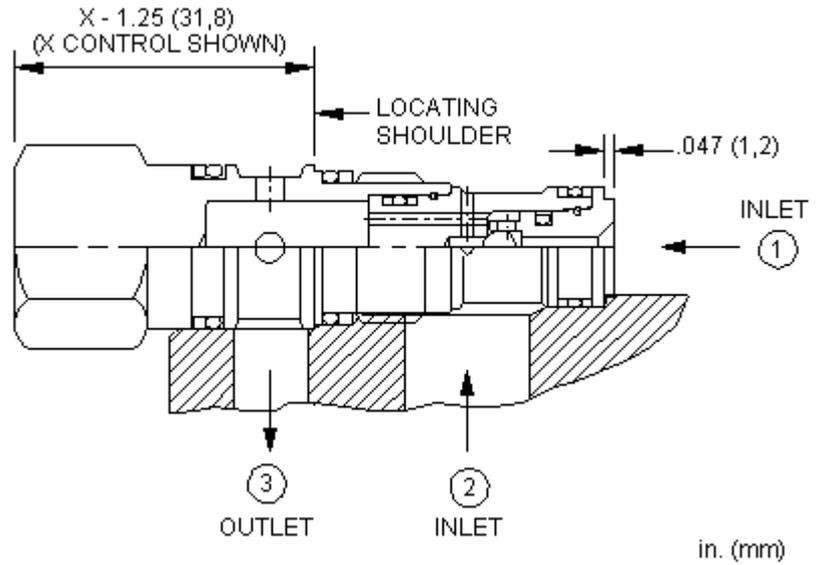
Das Wechselventil verbindet die Hochdruckseite zweier Zuläufe mit dem Signalabgriff. Der Signalabgriff ist an Anschluss 3.
