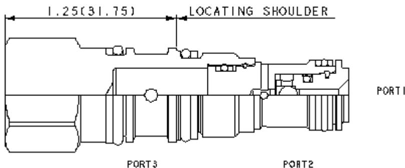
Le sélecteur de circuit simple bille relie la plus élevée des 2 lignes de pression à l'orifice du signal. Le signal de pression arrive sur l'orifice 3.
