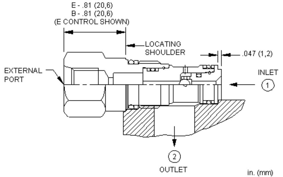
Le sélecteur de circuit simple bille relie la plus élevée des 2 lignes de pression à l'orifice du signal. L'une des 2 lignes de pression correspond à un orifice externe situé dans la partie hexagonale de la cartouche; le signal de pression arrive sur l'orifice 2.
