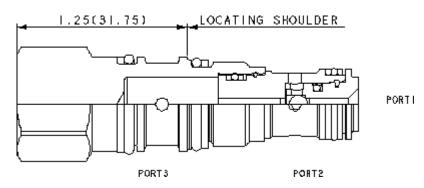
Das Wechselventil verbindet die Hochdruckseite zweier Zuläufe mit dem Signalabgriff. Der Signalabgriff ist an Anschluss 2.
