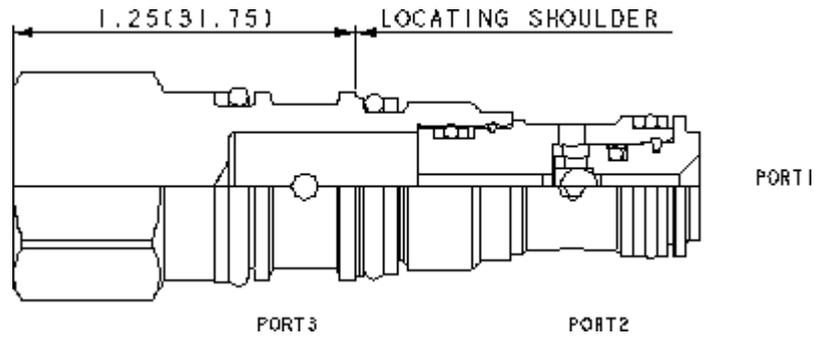
Le sélecteur de circuit simple bille relie la plus élevée des deux lignes de pression à l'orifice du signal. Le signal de pression arrive sur l'orifice 2.
