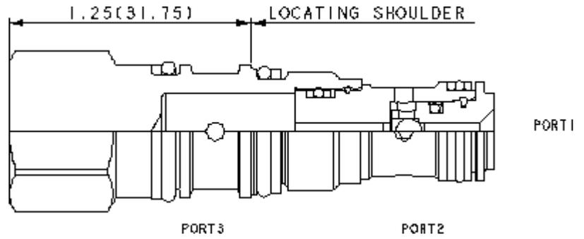
Das Wechselventil verbindet die Hochdruckseite zweier Zuläufe mit dem Signalabgriff. Der Signalabgriff ist an Anschluss 2.
