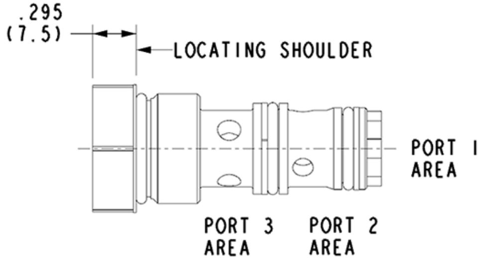
Le sélecteur de circuit simple bille relie la plus élevée des deux lignes de pression à l'orifice du signal. Le signal de pression arrive sur l'orifice 2.
