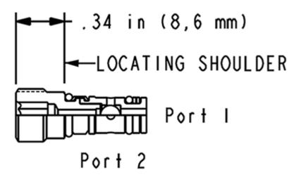
Das Wechselventil verbindet die Hochdruckseite zweier Zuläufe mit dem Signalabgriff. Der Signalabgriff ist an Anschluss 2.
