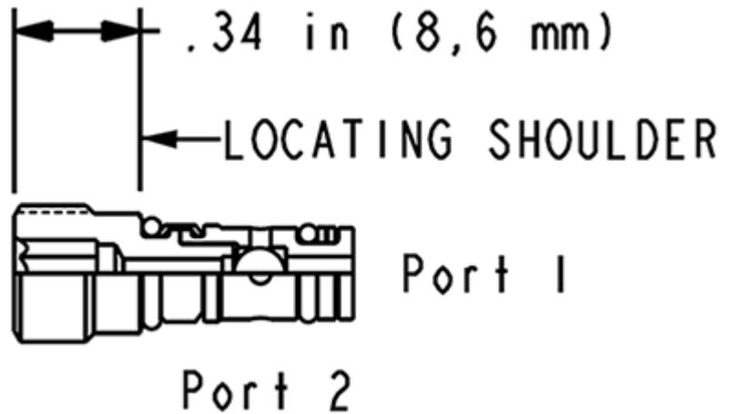
Le sélecteur de circuit simple bille relie la plus élevée des deux lignes de pression à l'orifice du signal. Le signal de pression arrive sur l'orifice 2.
