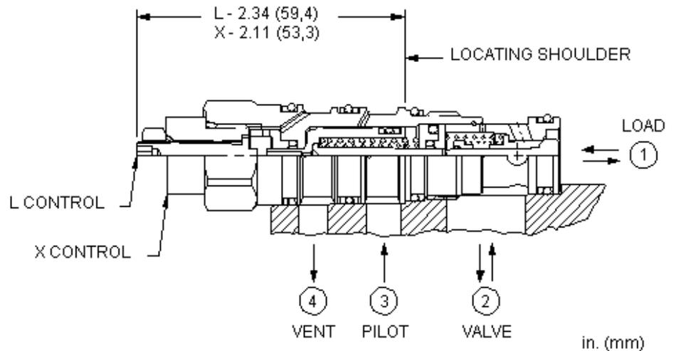
Dieses Ventil ist ein entsperrbares Rückschlagventil. Es hat einen abgedichteten Steuerkolben, einen Stahlsitz und ist entlastet. Es hat freien Durchfluss zur Last (Anschluss 2 nach 1) und sperrt in Gegenrichtung. Druck an Anschluss 3 öffnet das Ventil von Anschluss 1 nach 2. Der benötigte Steuerdruck ist direkt proportional zum Lastdruck an Anschluss 1. Das Ventil ist unabhängig von Druck an Anschluss 2, da der Federraum zum Anschluss 4 entlastet ist.
