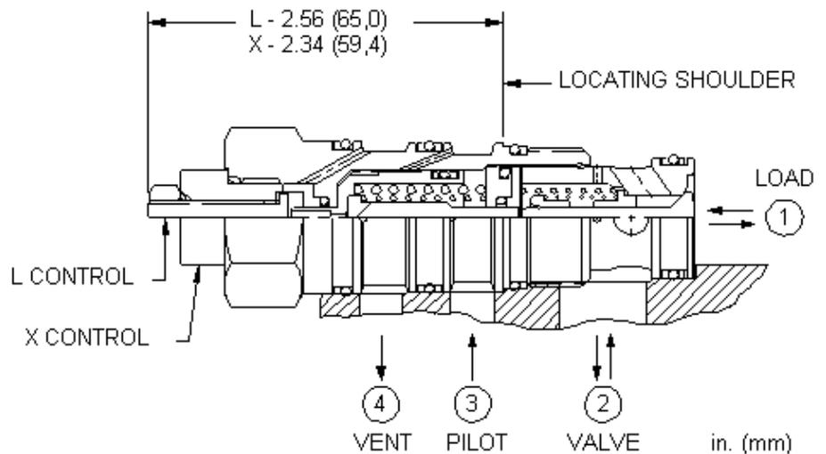
Dieses Ventil ist ein entsperrenbares Rückschlagventil. Es hat einen abgedichteten Steuerkolben, einen Stahlsitz und ist entlastet. Es hat freien Durchfluss zur Last (Anschluss 2 nach 1) und sperrt in Gegenrichtung. Druck an Anschluss 3 öffnet das Ventil von Anschluss 1 nach 2. Der benötigte Steuerdruck ist direkt proportional zum Lastdruck an Anschluss 1. Das Ventil ist unabhängig von Druck an Anschluss 2, da der Federraum zum Anschluss 4 entlastet ist.
