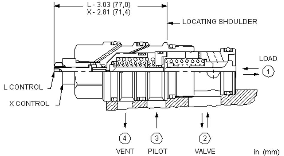
Dieses Ventil ist ein entsperrbares Rückschlagventil. Es hat einen abgedichteten Steuerkolben, einen Stahlsitz und ist entlastet. Es hat freien Durchfluss zur Last (Anschluss 2 nach 1) und sperrt in Gegenrichtung. Druck an Anschluss 3 öffnet das Ventil von Anschluss 1 nach 2. Der benötigte Steuerdruck ist direkt proportional zum Lastdruck an Anschluss 1. Das Ventil ist unabhängig von Druck an Anschluss 2, da der Federraum zum Anschluss 4 entlastet ist.
