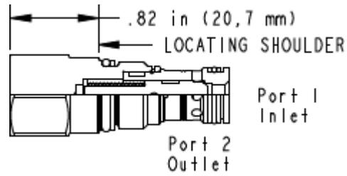
Rückschlagventile von SUN sind schaltende Ventile. Diese Version gibt den Volumenstrom von Anschluss 1 nach 2 frei und sperrt in umgekehrter Richtung.
