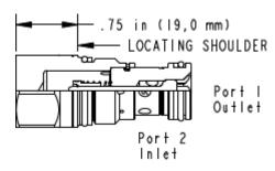
Rückschlagventile von SUN sind schaltende Ventile. Diese Version gibt den Volumenstrom von Anschluss 2 nach 1
