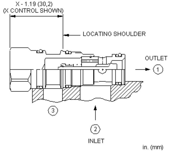
Dieses Rückschlagventil entspricht einem Standard Rückschlagventil mit zwei Anschlüssen in einer Einschraubbohrung mit drei Anschlüssen, wobei der Anschluss 3 des Einschraubventils verschlossen ist. Dieses Ventil ist einzusetzen in Schaltungen, in denen ein Rückschlagventil in einer vorhandene Einschraubbohrung mit drei Anschlüssen benötigt wird.
