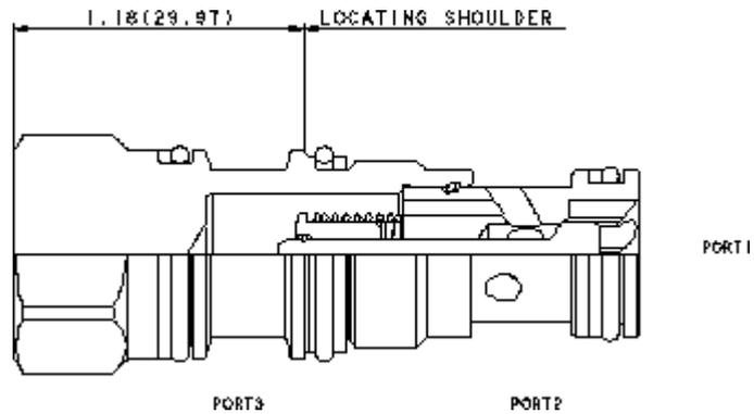
Les clapets anti-retour adaptables avec débit libre depuis le côté vers le nez fonctionnent comme des clapet anti-retour à 2 orifices, mais dans une cavité à 3 chambres avec l'orifice 3 bloqué. Ces valves sont utiles dans un circuit nécessitant un clapet simple alors qu'une cavité à 3 chambres existe déjà
