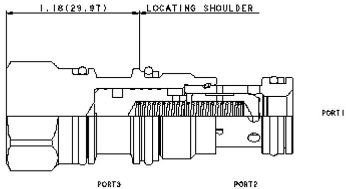
Dieses Rückschlagventil entspricht einem Standard Rückschlagventil mit zwei Anschlüssen in einer Einschraubbohrung mit drei Anschlüssen, wobei der Anschluss 3 des Einschraubventils verschlossen ist. Dieses Ventil ist einzusetzen in Schaltungen, in denen ein Rückschlagventil in einer vorhandene Einschraubbohrung mit drei Anschlüssen benötigt wird.
