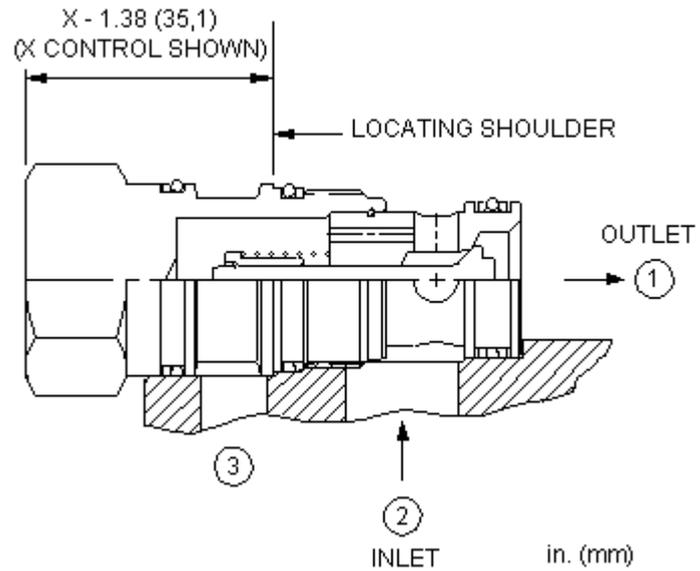
Dieses Rückschlagventil entspricht einem Standard Rückschlagventil mit zwei Anschlüssen in einer Einschraubbohrung mit drei Anschlüssen, wobei der Anschluss 3 des Einschraubventils verschlossen ist. Dieses Ventil ist einzusetzen in Schaltungen, in denen ein Rückschlagventil in einer vorhandene Einschraubbohrung mit drei Anschlüssen benötigt wird.
