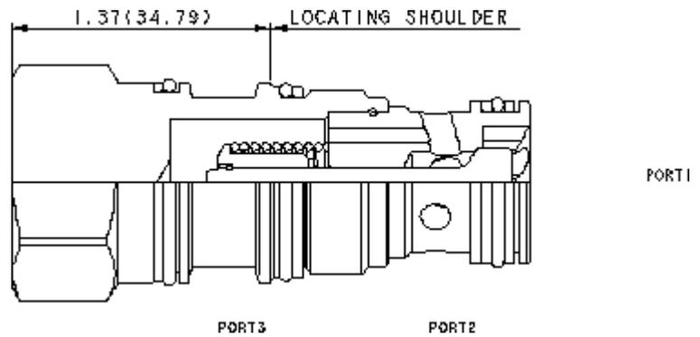
Dieses Rückschlagventil entspricht einem Standard Rückschlagventil mit zwei Anschlüssen in einer Einschraubbohrung mit drei Anschlüssen, wobei der Anschluss 3 des Einschraubventils verschlossen ist. Dieses Ventil ist einzusetzen in Schaltungen, in denen ein Rückschlagventil in einer vorhandene Einschraubbohrung mit drei Anschlüssen benötigt wird.
