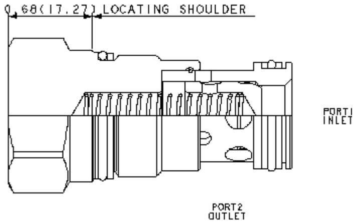
Rückschlagventile von SUN sind schaltende Ventile. Diese Version gibt den Volumenstrom von Anschluss 1 nach 2 frei und sperrt in umgekehrter Richtung.
