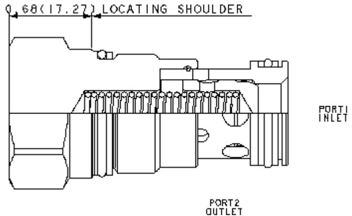
Rückschlagventile von SUN sind schaltende Ventile. Diese Version gibt den Volumenstrom von Anschluss 1 nach 2 frei und sperrt in umgekehrter Richtung.
