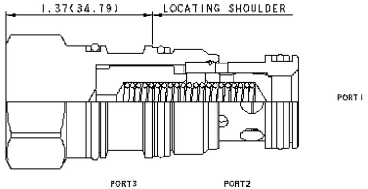
Dieses Rückschlagventil entspricht einem Standard Rückschlagventil mit zwei Anschlüssen in einer Einschraubbohrung mit drei Anschlüssen, wobei der Anschluss 3 des Einschraubventils verschlossen ist. Dieses Ventil ist einzusetzen in Schaltungen, in denen ein Rückschlagventil in einer vorhandene Einschraubbohrung mit drei Anschlüssen benötigt wird.
