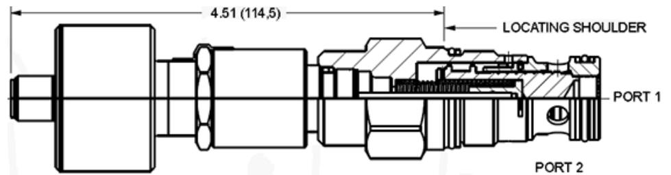
Rückschlagventile von SUN sind schaltende Ventile. Diese Version gibt den Volumenstrom von Anschluss 1 nach 2 frei und sperrt in umgekehrter Richtung. Das Ventil hat einen Positionsschalter, der die geschlossene Position überwacht.
