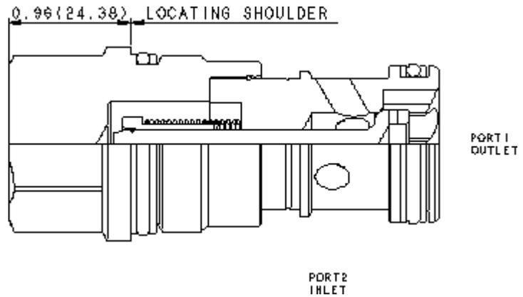
Rückschlagventile von SUN sind schaltende Ventile. Diese Version gibt den Volumenstrom von Anschluss 2 nach 1 frei und sperrt in umgekehrter Richtung.
