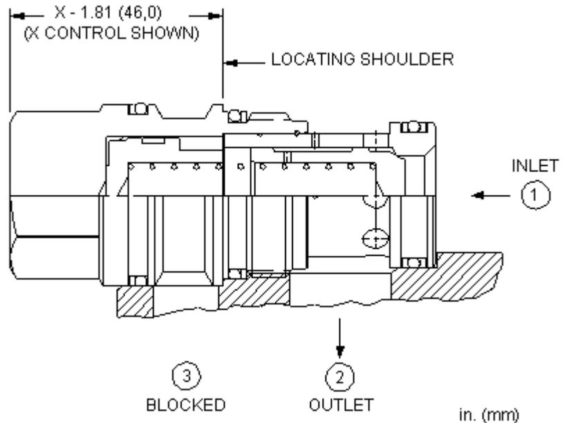
Dieses Rückschlagventil entspricht einem Standard Rückschlagventil mit zwei Anschlüssen in einer Einschraubbohrung mit drei Anschlüssen, wobei der Anschluss 3 des Einschraubventils verschlossen ist. Dieses Ventil ist einzusetzen in Schaltungen, in denen ein Rückschlagventil in einer vorhandene Einschraubbohrung mit drei Anschlüssen benötigt wird.
