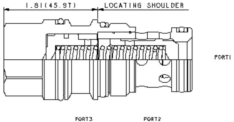
Les clapets anti-retour adaptables avec débit libre depuis le nez vers le côté fonctionnent comme des clapet anti-retour à 2 orifices, mais dans une cavité à 3 chambres avec l'orifice 3 bloqué. Ces valves sont utiles dans un circuit nécessitant un clapet simple alors qu'une cavité à 3 chambres existe déjà
