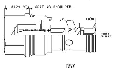
Rückschlagventile von SUN sind schaltende Ventile. Diese Version gibt den Volumenstrom von Anschluss 2 nach 1 frei und sperrt in umgekehrter Richtung.
