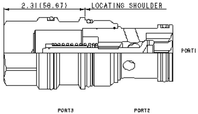
Les clapets anti-retour adaptables avec débit libre depuis le côté vers le nez fonctionnent comme des clapet anti-retour à 2 orifices, mais dans une cavité à 3 chambres avec l'orifice 3 bloqué. Ces valves sont utiles dans un circuit nécessitant un clapet simple alors qu'une cavité à 3 chambres existe déjà
