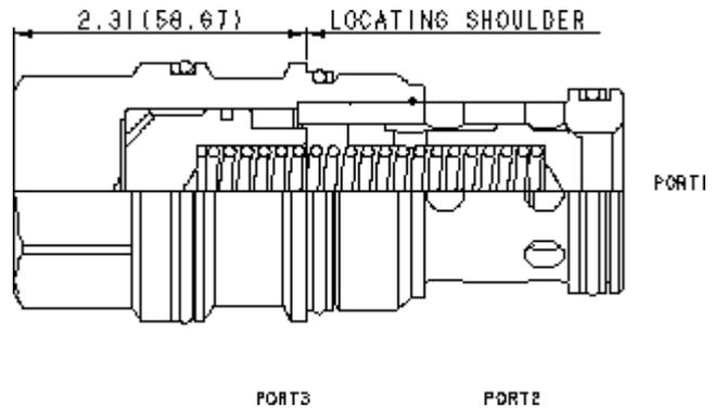
Les clapets anti-retour adaptables avec débit libre depuis le nez vers le côté fonctionnent comme des clapet anti-retour à 2 orifices, mais dans une cavité à 3 chambres avec l'orifice 3 bloqué. Ces valves sont utiles dans un circuit nécessitant un clapet simple alors qu'une cavité à 3 chambres existe déjà
