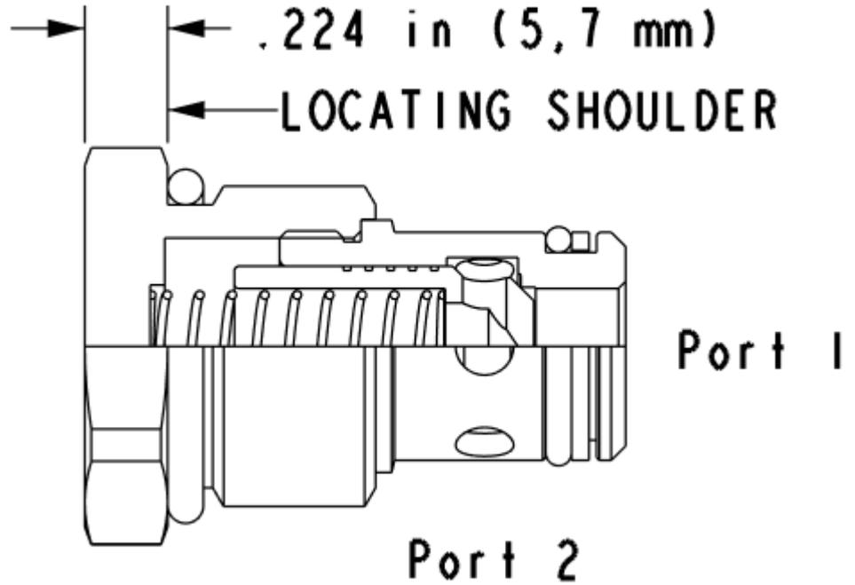
Rückschlagventile von SUN sind schaltende Ventile. Diese Version gibt den Volumenstrom von Anschluss 1 nach 2 frei und sperrt in umgekehrter Richtung.
