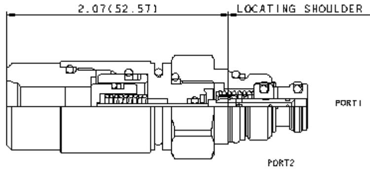
Dieses hydraulisch betätigte 2/2-Wege Vorsteuerventil mit Federrückstellung ist in Ruhestellung offen oder geschlossen erhältlich und eignet sich nur für kleine Volumenströme. Das Ventil nutzt das T-8A Bohrkonzzept und eignet sich als Vorsteuerventil in Hauptstufenventilen von SUN.
