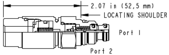
Dieses pneumatisch betätigte 2/2-Wege Vorsteuerventil mit Federrückstellung ist in Ruhestellung offen oder geschlossen erhältlich und eignet sich nur für kleine Volumenströme. Das Ventil nutzt das T-8A Bohrkonzzept und eignet sich als Vorsteuerventil in Hauptstufenventilen von SUN.
