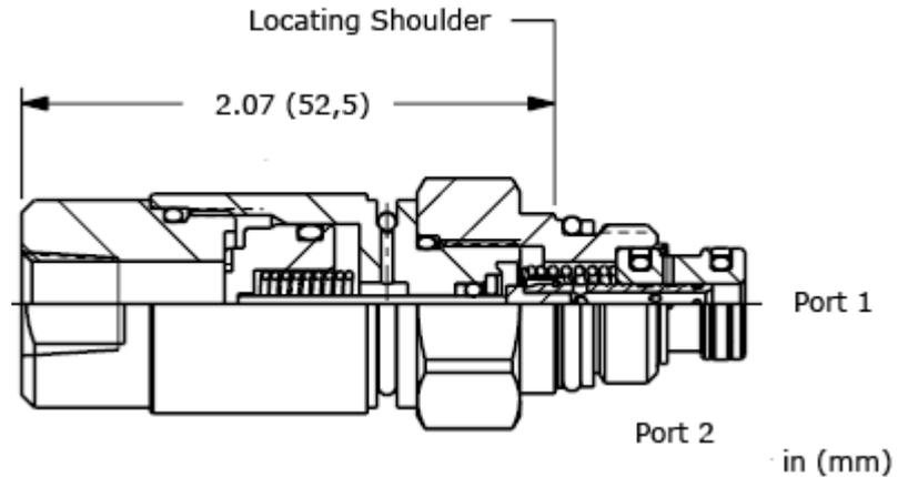
Dieses pneumatisch betätigte 2/2-Wege Vorsteuerventil mit Federrückstellung ist in Ruhestellung offen oder geschlossen erhältlich und eignet sich nur für kleine Volumenströme. Das Ventil nutzt das T-8A Bohrkonzzept und eignet sich als Vorsteuerventil in Hauptstufenventilen von SUN.
