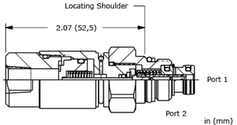
Ces étages pilotes directionnels 2 voies/2 positions à rappel par ressort, sont à commande pneumatique et existent en version normalement ouverte ou normalement fermée. Ces cartouches sont conçues pour des débits de pilotage et se montent dans une cavité Sun T-8A ce qui en fait le choix idéal pour piloter les cartouches d'étage de puissance Sun.
