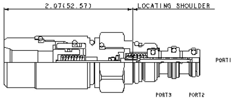
Dieses hydraulisch betätigte 3/2-Wege Vorsteuerventil mit Federrückstellung ist in zwei Schieberausführungen erhältlich: In Ruhestellung geöffnet von 1 nach 2 und in Ruhestellung geöffnet von 1 nach 3. Das Ventil eignet sich nur für kleine Volumenströme.
