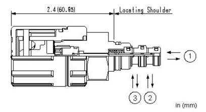
Ces distributeurs de pilotage 3 voies/2 positions à commande manuelle offrent 2 configurations de tiroirs différents : 1 vers 2 passants et 3 bloqué ou 1 vers 3 passant et 2 bloqué. Ces cartouches sont conçues pour des débits de pilotage et se montent dans une cavité Sun T-8A ce qui en fait le choix idéal pour piloter les cartouches d'étage de puissance Sun. La valve est actionnée par la commande manuelle rotative Sun qui est conçue pour un usage occasionnel uniquement.
