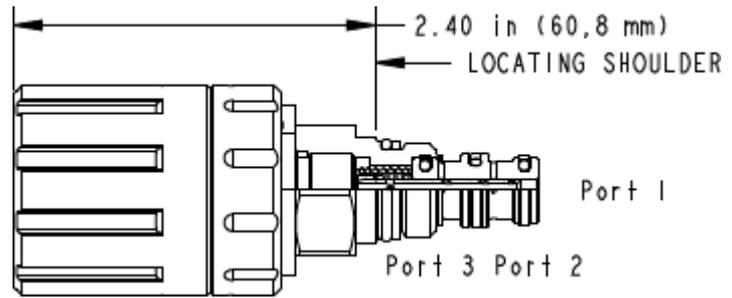
Dieses handbetätigte 3/2-Wegeventil für Vorsteuerfunktionen ist in zwei Kolbenausführungen erhältlich: In Ruhestellung von Anschluss 1 nach 2 oder in Ruhestellung von 1 nach 3 geöffnet. Die Betätigung dieses Vorsteuerventils geschieht mit der dreh- und rastbaren Handbetätigung von SUN (nicht geeignet für Dauergebrauch).
